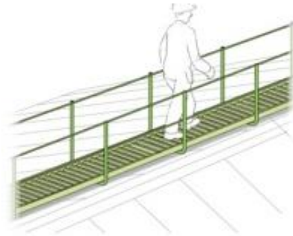
Figur 58c. Gångbrygga med skyddsräcken på båda sidor vid avstånd < 1 meter från taknock.
