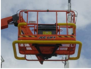
Figur 11. Bomlift med förankringsanordning för PFU
