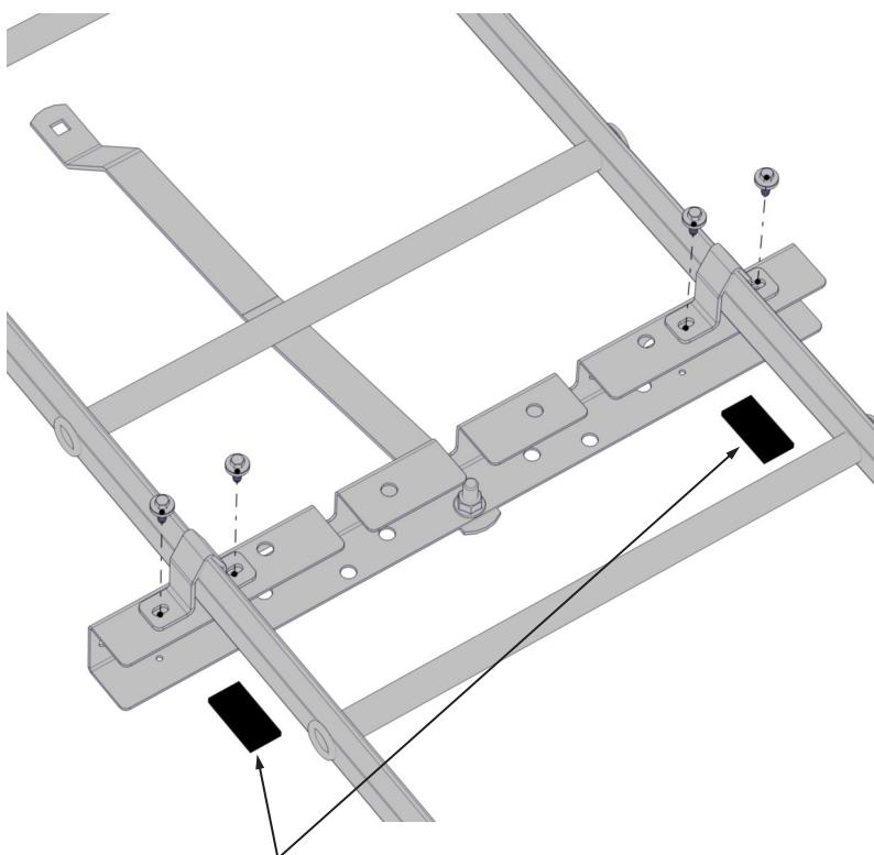
Montera fästet mot fästjärnet. Infästning i tak var 6:e meter, dock minst 2 st/steg. Avstånd mellan stöd max 2000 mm, max överhang 450 mm.
